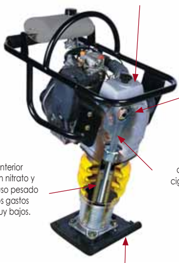
Alta velocidad de viaje con mejorado ángulo de inclinación del pie, optimizados sistemas de resortes y bajo centro de gravedad.
