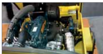
Motore Kubota assemblato longitudinalmente per assicurare un facile accesso per la manutenzione
