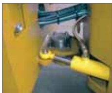
Einzigartiges Schwingdrehgelenk mit Schmierstelle
