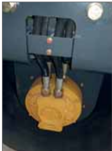
Schmierstellen an jeder Walze Poclair-Antriebsmotoren
