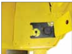
Kraftstofftankdeckel mit einfachem Zugang von dem Fahrerstand aus
