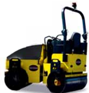
Luz de advertencia giratoria y protección ROPS
