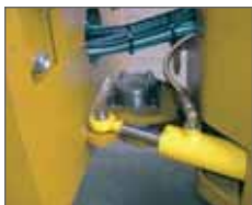
Articulación única de pivote con entrada para engrasar
