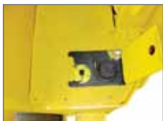
Tapa para entrada del diésel con fácil acceso en el suelo del operador
