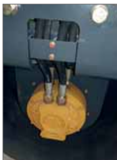
Ponto de lubrificação em cada rolo com Motor Poclair.
