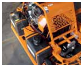
2 depósitos de água
