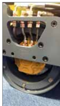
Duas bombas hidráulicas Poclair
