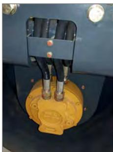
Schmierstellen an jeder Walze Poclair-Antriebsmotoren
