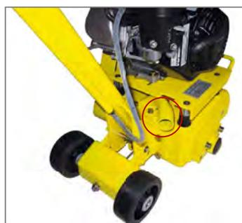
Ventil für Staubfilter
