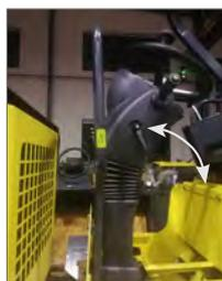
Verstellbares ergonomisches Lenkrad
