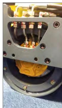
Zwei hydraulische Pumpen von Poclairn
