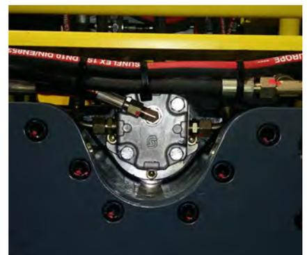
Vibrationsmotor von Sauer Danfoss
