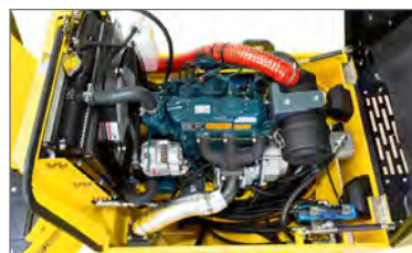
Motor turbo para impulsar potencia extra 44 CV
