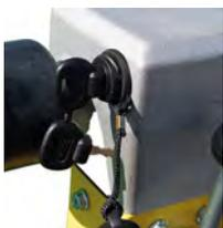
Caja de arranque eléctrica integrada al mango
