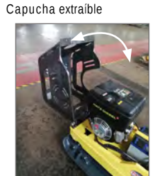
Fácil acceso para servicio de la batería y arranque
