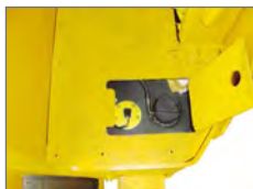
Tampão do depósito de combustível de fácil acesso situado na plataforma do operador.
