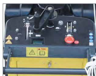
Painel de controlo moderno com conta-horas
