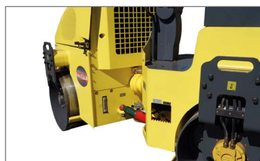
Articulação dupla com pontos de lubrificação de patente 'Pac-pivot'
