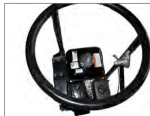
Acelerador colocado no centro do volante
