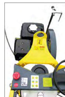
Point de levage central
