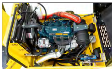
Moteur pour une puissance amplifiée de 44 ch
