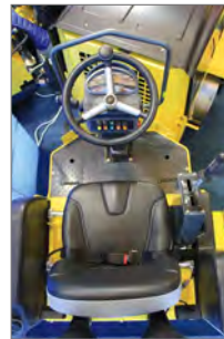
Siège ergonomique antivibratile avec contacteur de sécurité
