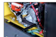
Manivelle pour démarrage manuel sur modèle Kubota
