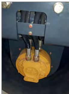
Smörjpunkter vid varje cylinder Poclair driv motorer
