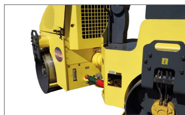
Doble articulación con puntos para lubricación "Pac-pivot" (patentado)
