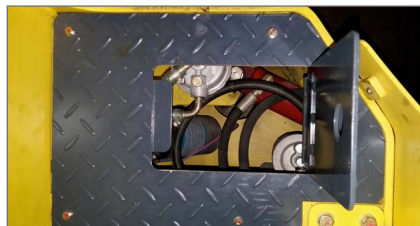
Acceso fácil y protección de filtros y combustible
