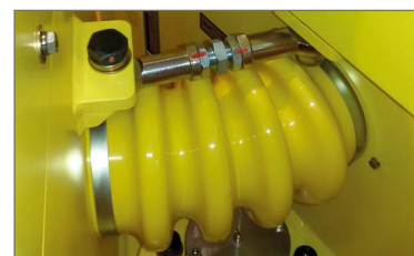
Doble articulación con puntos para lubricación "Pac-pivot" (patentado)
