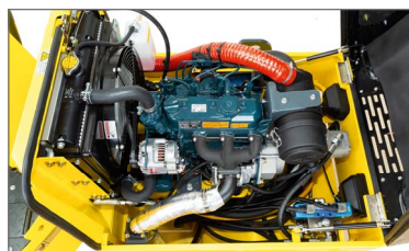
Motor turbo para impulsar potencia extra 44 CV
