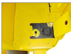
Tapa para entrada del diesel con fácil acceso en el suelo del operador
