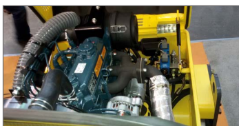
Motor KUBOTA montado directo en línea para facilidad de servicio y mantenimiento.
