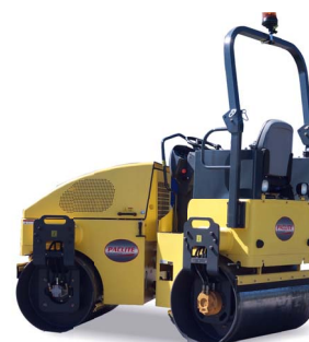
Luz de advertencia giratoria y protección ROPS
