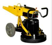
**PAC-GRIND 400 & PAC-GRIND 500 Equipo Estándar:** Tapa de polvo, llave para cambiar el disco, puerto de fijación de 50 mm para una manguera de vacío externa, cable de 2 m.
