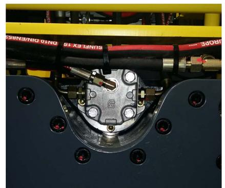
Motor de vibración de Sauer Danfoss
