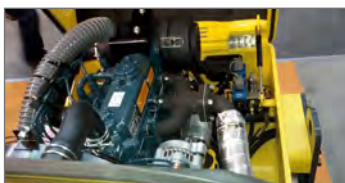
Moteur Kubota assemblé de manière linéaire afin de permettre un accès et une maintenance faciles et rapides.
