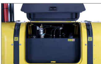
Capot d'ouverture, des composants en carbone pour réduire le poids
