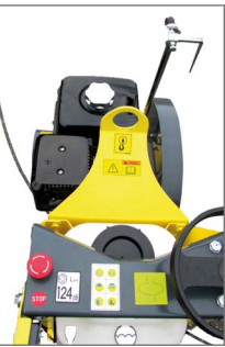
Point de levage central
