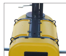
Anneaux de levage pour faciliter le chargement lors du transport.
