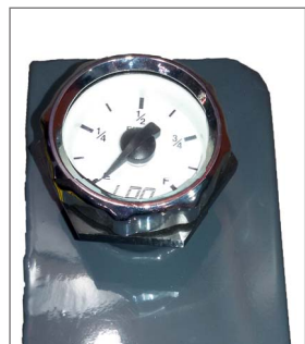
Contrôle du niveau d'eau
