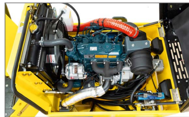
Moteur pour une puissance amplifiée de 44 ch
