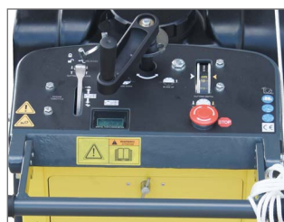
Panneau de contrôle avancé avec compteur d'heures
