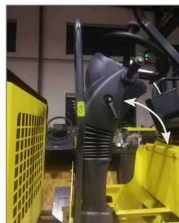
Volant ergonomique ajustable
