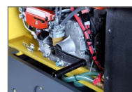
Manivelle pour démarrage manuel sur modèle Kubota
