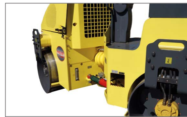
Double articulation avec points de graissage 'Pac-pivot' (breveté)
