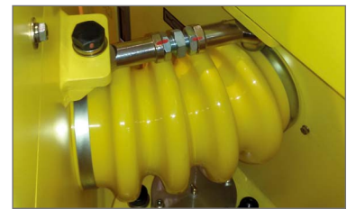
Double articulation avec points de graissage 'Pac-pivot' (breveté)
