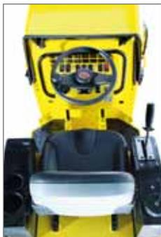
Siège ergonomique antivibratile avec contacteur de sécurité
