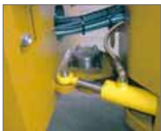
Einzigartiges Drehgelenk mit Schmierpunkt
