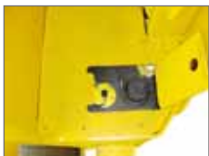
Diesekraftstofftankdeckel mit einfachem Zugang von der Bediener-Plattform
