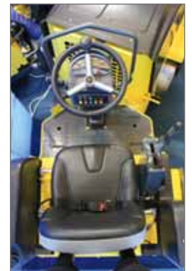
Siège ergonomique antivibratile avec contacteur de sécurité
