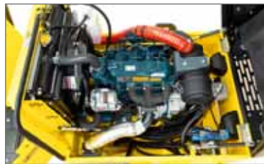
44 PS Turbomotor zur Verstärkung der Leistung
