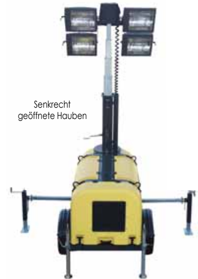
Verstellbare Stützen (Breite und Position) zur Anpassung an den Boden
