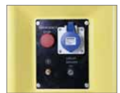
Steuerungsbox mit einem Ventilator an der Rückseite Netzsteckdose CE
