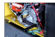
Elstart med manuell nödstart i standardutförande
