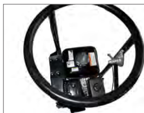
Gasreglaget monterat lättillgängligt
