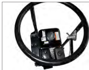
Accélérateur placé au centre sur la poignée
