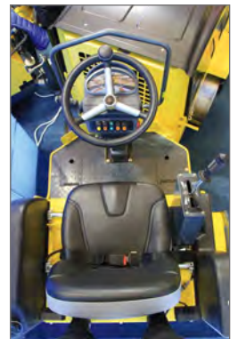
Siège ergonomique antivibratile avec contacteur de sécurité
