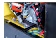
Manivelle pour démarrage manuel sur modèle Kubota
