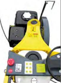
Point de levage central
