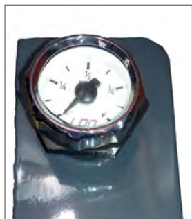
Contrôle du niveau d'eau
