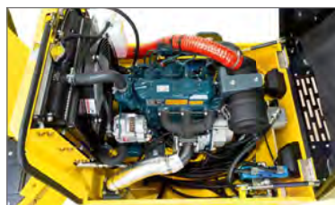
Moteur pour une puissance amplifiée de 44 ch
