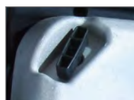
Démarrateur manuel de secours : lanceur
