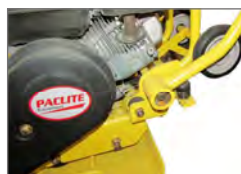
Système unique pour réduire les vibrations "mains-bras"
