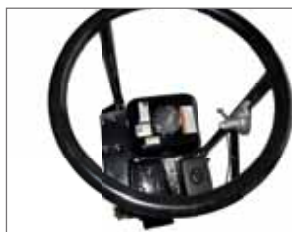
Acceleratore posizionato centralmente
