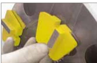
Segmentos diamantados fáciles de cambiar, sin necesitar herramientas.
