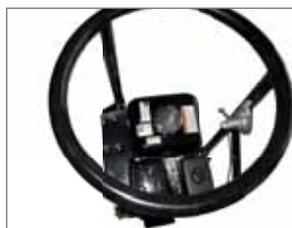
Acelerador centralmente colocado
