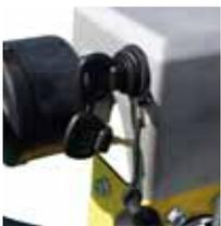
Caja de arranque eléctrica integrada al mango
