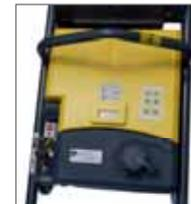
Desconexión del motor en el mango
