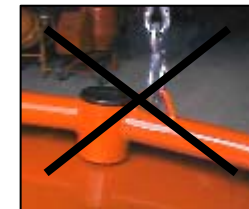
Fig. 13 – Sistema de elevação só para cargas e descargas. Système d'élevation à n'utiliser que pour son transport
