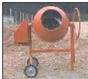
Fig. 2 – Betoneira nivelada e com estabilidade. Bétonnière nivelée et avec stabilité
