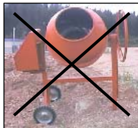
Fig. 1 – Betoneira desnivelada e sem estabilidade. Bétonnière dénivelée et sans stabilité
