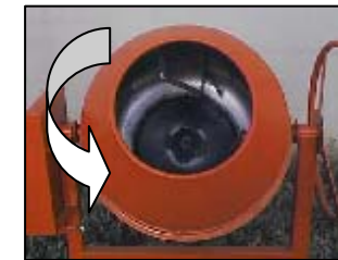
Fig. 4 – Sentido de rotação do tambor, anti-horário. Sens de rotation de la cuve: dans le sens inverse des aiguilles d'une montre
