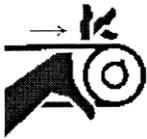
NE JAMAIS utiliser la machine avec des couvertures ou des dispositifs de protection retirés. Gardez les doigts, les mains, les cheveux et les vêtements à l'écart de toutes les pièces mobiles pour éviter toute blessure ou accident graves.
