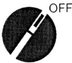
TOUJOURS placer l'interrupteur ON / OFF du moteur en position "OFF" lorsque la machine n'est pas utilisée.
