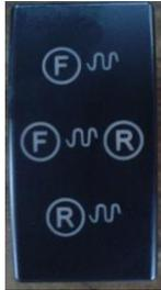
F presionada significa vibración del tambor delantero solamente
