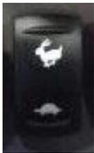
En este modo, el conejo indica alta velocidad en RPM
