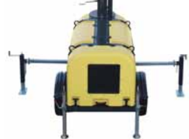
Gatos regulables en anchura y posición adaptándose al terreno
