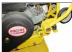
Sistema para reducir HAV (vibración mano-brazo)
