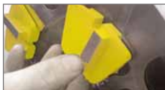
Segmentos diamantados fáciles de cambiar, sin necesitar herramientas.
