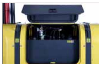
Cubierta de servicio, componentes de carbono para reducir el peso
