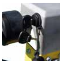
Caja de arranque eléctrica integrada al mango
