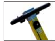
Mango con bajo HAV con monturas de caucho y servo control
