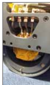
Deux pompes hydrauliques Poclairn
