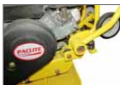
Système unique pour réduire les vibrations "mains-bras"
