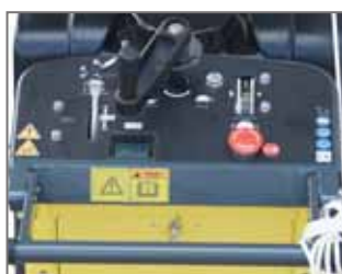
Panneau de contrôle avancé avec compteur d'heures
