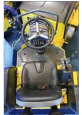
Siège ergonomique antivibratile avec contacteur de sécurité
