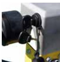
Boîtier de démarrage électrique
