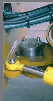
Articulación única de pivote con entrada para engrasar
