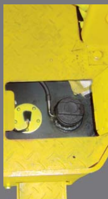
Tapa para entrada del diesel con fácil acceso en el suelo del operador
